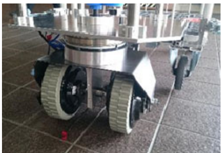
試作機の2つの電動車輪・受動関節部分
