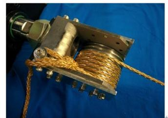
図11 端部固定の実施例(2tの荷重に耐える)
