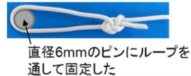
図10 ピンでの固定
