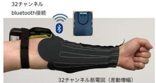
図1. 着るだけで測れる筋電計測装置
