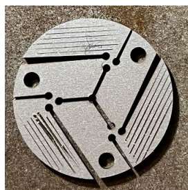
図1.（提案発明）多方向ひずみを計測できるコンプライアントメカニズムのデザイン
